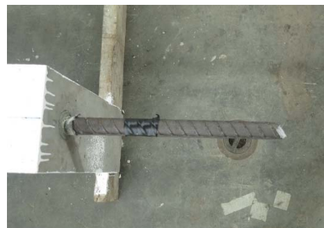
(b) 鋼筋斷裂
