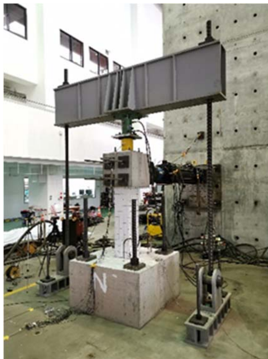
圖 5 反力牆反覆載重實驗試體安裝配置情形
